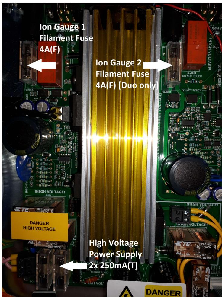
**BEFORE ATTEMPTING TO CHECK THE FUSES, REMOVE ALL CONNECTORS FROM THE CONTROLLER (ESPECIALLY THE MAINS) AND ALLOW 10-15 MINUTES FOR THE HIGH VOLTAGES TO DISCHARGE FROM THE STORAGE CAPACITORS.**
